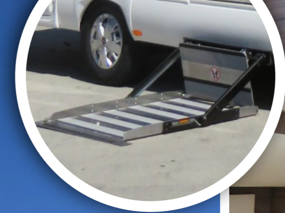
Sollevatore Handytech con portata 300 Kg (di serie).
