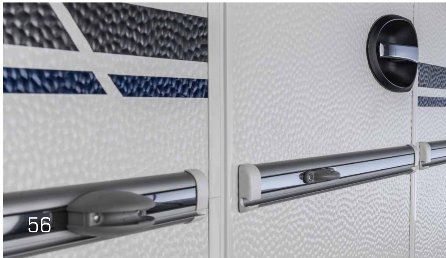
Solide modanature con dispositivo di bloccaggio della porta
