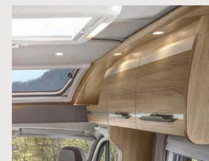
**Robusti e su misura.** Una complessa tecnica a tasselli consente di ottenere una precisione di accoppiamento ottimale ed una struttura decisamente più stabile. Inoltre usiamo massicci profili in alluminio che rendono i mobili non solo più stabili, ma anche sensibilmente più leggeri (a seconda del modello)
