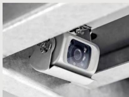
**Telecamera sulle valvole di scarico ed elettrovalvola di scarico.** Gli assali del SUN I possono essere equipaggiati con una telecamera per le acque reflue per semplificare il posizionamento del veicolo sullo scarico (opzionale). La valvola di scarico elettrica standard può essere comodamente azionata dalla cabina di guida (a seconda del modello / opzionale).
