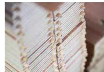
**Stabili e su misura.** Una complessa tecnica a tasselli consente di ottenere una precisione di accoppiamento ottimale ed una struttura decisamente più stabile. Inoltre usiamo massicci profili in alluminio che rendono i mobili non solo più stabili, ma anche sensibilmente più leggeri (a seconda del modello).
