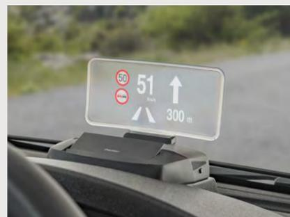
**Il display head-up garantisce una sicurezza maggiore.** Tutti i dati rilevanti come ad esempio le istruzioni del sistema di navigazione Pioneer vengono proiettati direttamente nel vostro campo visivo (opzionale).
