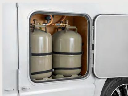
**Pratico gavone portabombole longitudinale.** Il gavone portabombole longitudinale ha un accesso particolarmente agevole e consente di sostituire le bombole di gas ancora più in fretta. È predisposto per due bombole da 11 kg, poste una accanto all'altra (su tutte le serie).
