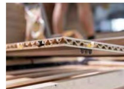
**Mix innovativo di materiali.** Per i nostri mobili utilizziamo soprattutto materiali innovativi leggeri e robusti. L'uso combinato della tecnica a tasselli ed i profili in alluminio riducono il peso del veicolo garantendo inoltre una maggiore stabilità della scocca (a seconda del modello).
