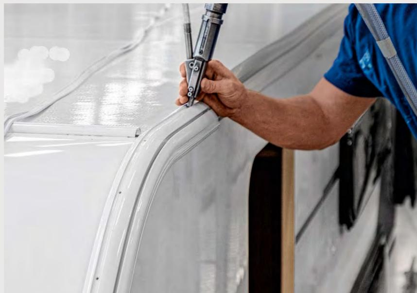
**Robusto Pro.Tec Frame.** Pro.Tec Frame è una fascia di alluminio particolarmente solida che collega fra loro fiancate, parete anteriore, parete posteriore e tetto. Migliora la stabilità della struttura, prolungando la durata del veicolo nel suo insieme. Un particolare punto di forza: Pro.Tec Frame racchiude una camera che impedisce al mastice di fuoriuscire, per un risultato estetico più pulito (autocaravan/a seconda del modello).
