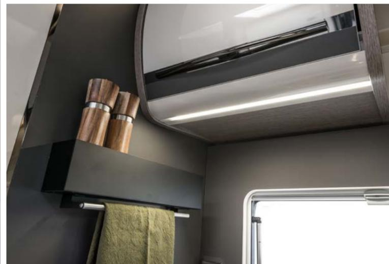
Copertura in laminato con finitura tinta unita a protezione della finestra, con cornice luminosa a LED e porta spezie.
